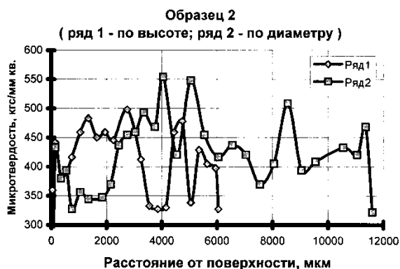
Рисунок 4 – Микротвердость образца на основе кобальта
