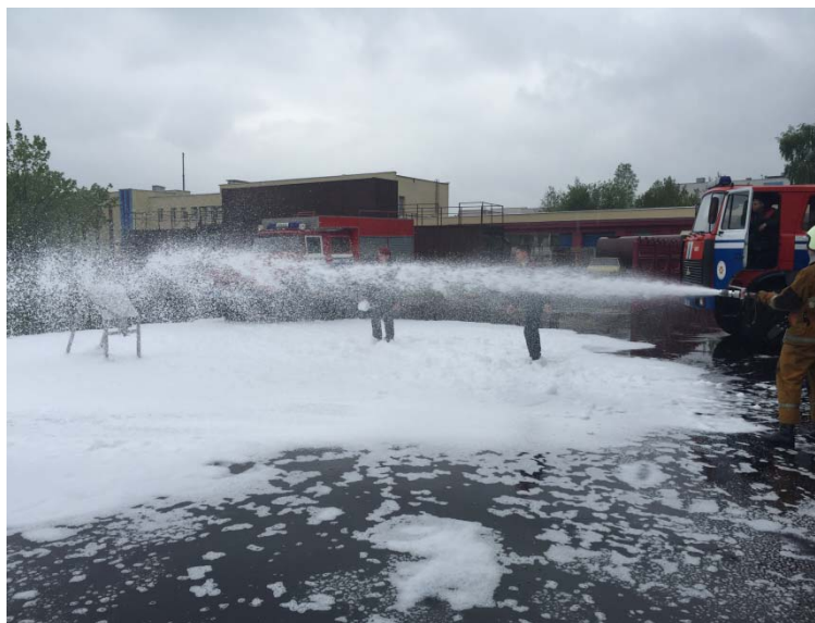
Рисунок 4 – Исследование кратности пены водопенного насадка
