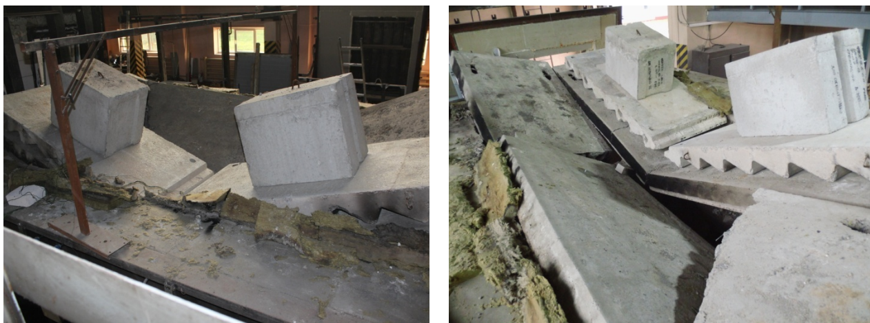
Рисунок 16 – Железобетонные плиты после проведения огневых испытаний
