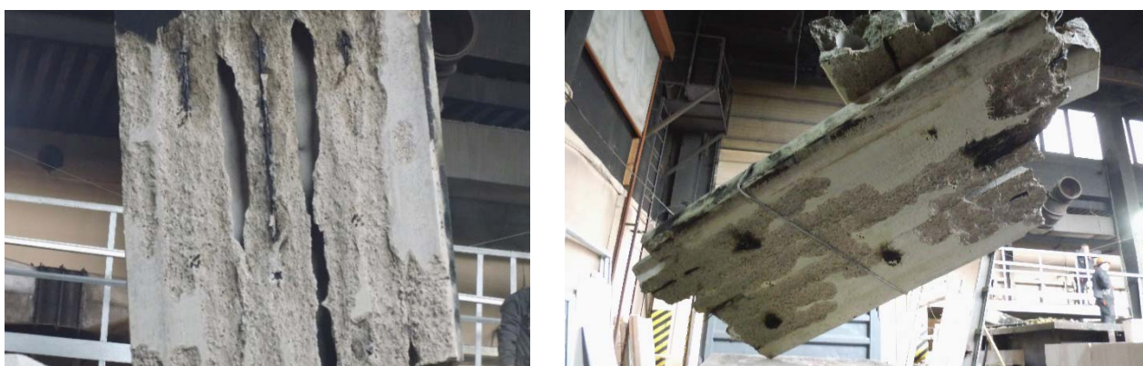
Рисунок 7 – Обогреваемая поверхность железобетонных плит после проведения огневых испытаний
