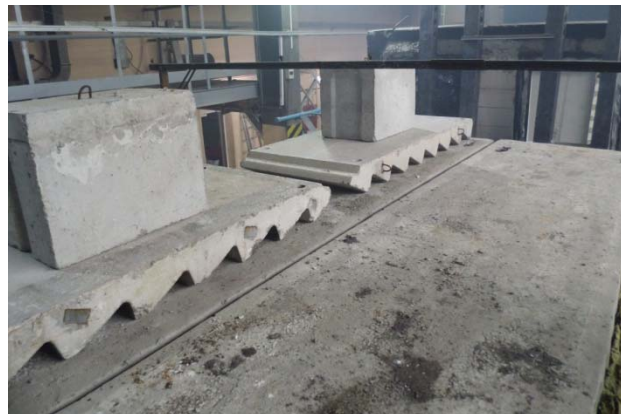
Рисунок 4 – Железобетонные плиты до проведения огневых испытаний
