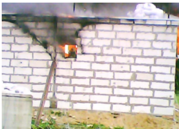
Рисунок 8 – Характер прогрева и разрушения стены из ячеистобетонных блоков по данным тепловизионной съемки на 51 минуте испытаний
