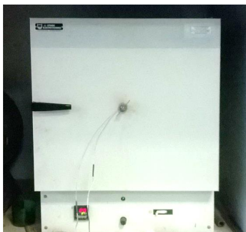
а) общий вид камерной электропечи
