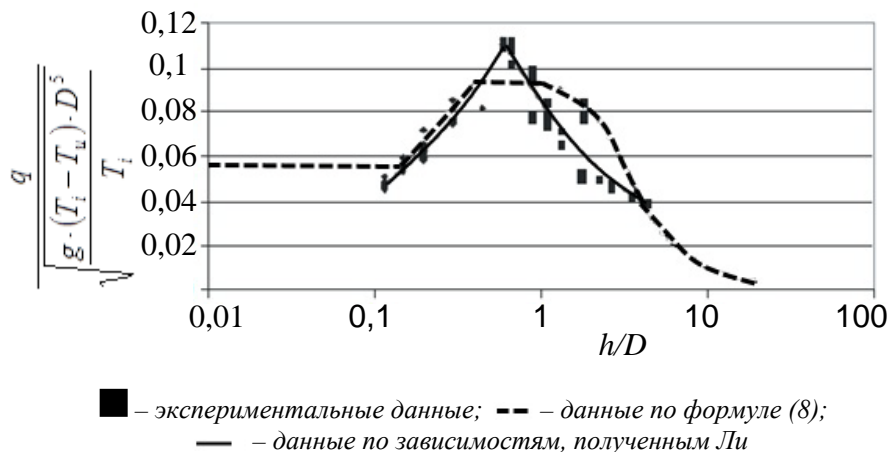
Рисунок 2. – Измеренный безразмерный расход воздуха как функция h/D [20]
