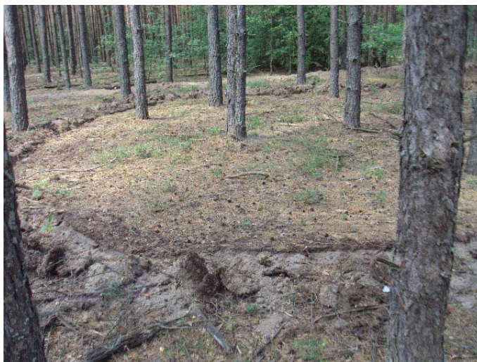
A – зона пуска огня ( d = 1 м); B – зона ЛГМ ( d = 8-12 м); B – минерализованная полоса шириной 1,4 м; Г – зона ЛГМ для контроля температуры в его слое
