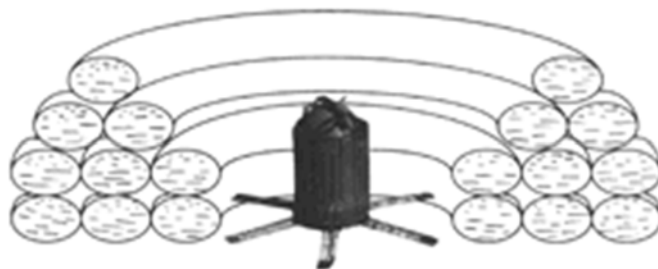
Рисунок 3. – Создание защитного экрана путем укладки пожарного рукава в водонаполненном состоянии
